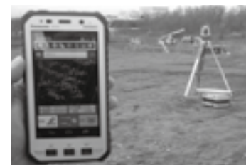
CADデータを事前登録し、杭ナビと連動するとプリズムマンの現在地がCAD図上に標記されおおよその位置出し可能。▶P.7
