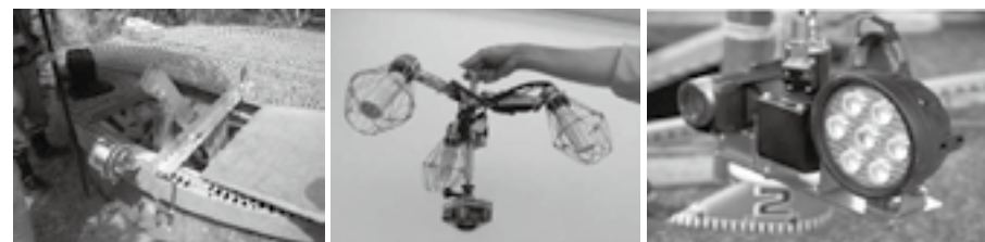
専用架台と2種類のカメラを用いた集水井内の点検技術▶P.23
